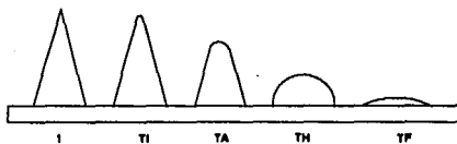
Figura 1.3.- Referencias visuales de las diferentes temperaturas de la ceniza: 1-estado inicial, TI-temperatura inicial de deformación, TA-temperatura de ablandamiento, TH-temperatura hemisférica y, TF-temperatura de fluidización [Ref. 4].
