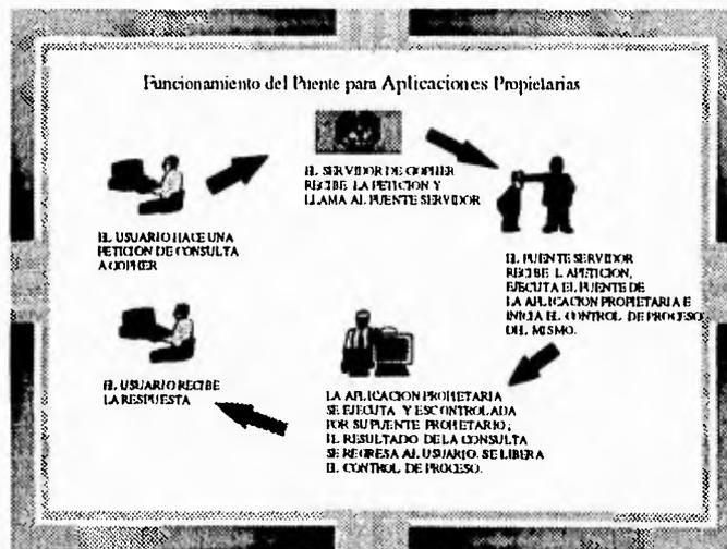
Ilustración 1 Funcionamiento del puente para aplicaciones propietarias
