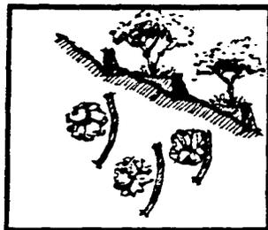
1.3. Erosión de moderada a severa con pendientes de 20 o más. Estabilización por uso de rellenos de monte o terracedo por relleno. (Ver fig. 1.3.)
