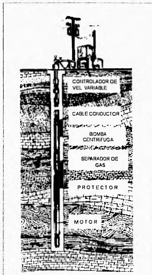
FIG. 2.1 APAREJO CONVENCIONAL DE UN SISTEMA DE BOMBEO ELECTROCENTRIFUGO
