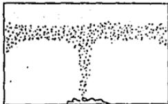
Esta figura muestra un fuego incipiente que puede ser autoextinguible o que consumirá el material por completo sin producir flama. En este caso, el humo nunca llega a tener temperatura suficiente como para llegar a la parte más alta.
