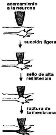
FIG. 14. El inicio del registro de corrientes en porciones de membrana aislada (Patch-Clamp), requiere de la formación de un sello celular de alta resistencia; para ello, es necesario acercar una pipeta recién elaborada a una porción limpia de la membrana celular. Posteriormente, cuando el sello muestra propiedades de una resistencia muy alta, utilizando un vibrador de alta frecuencia, se rompe la porción interna de esta membrana celular.
