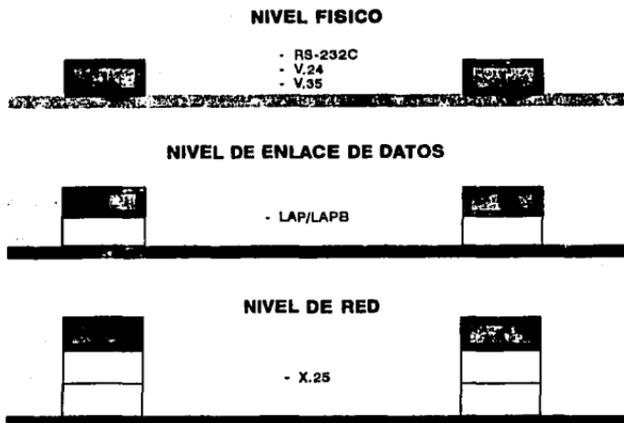
Figura 1.9.1 Capas inferiores del modelo OSI
