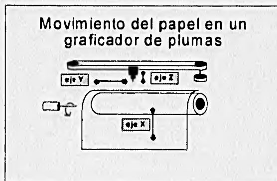
Fig. 2.1 Movimiento del papel de un graficador de plumas
