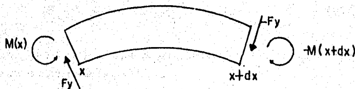
Figura 7. Momentos de flexión y fuerzas cortantes en una varilla.
