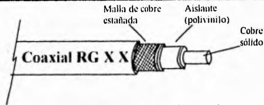
Figura 1.1 Estructura del cable coaxial.
