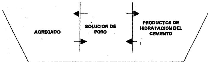
FIG. 2.1 INICIO DEL TRANSPORTE DE MASA DE LA REACCION ALCALI-SILICE. TRAYECTORIA DE TRANSFERENCIA ENTRE LA SOLUCION DE PORO Y EL AGREGADO. TAMBIEN PUEDE OCURRIR UNA TRAYECTORIA SECUNDARIA ENTRE LOS SOLIDOS, AGREGADO Y PASTA DE CEMENTO
