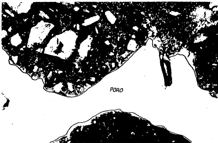
Foto 6. Poro de forma irregular en contacto con material reactivo. Observación con Luz Paralela. Muestra II-26-23.
