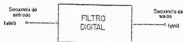
Figura 2.1: Un filtro digital transforma la secuencia de entrada  $x(n)$  en la secuencia de salida  $y(n)$ .
