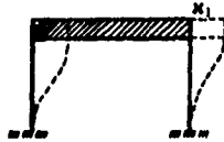
Figura 1.3 Estructura de un grado de libertad.
