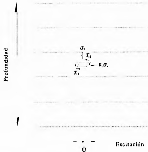
Fig 2.1 Estado de de esfuerzos de un elemento de suelo sujeto a la propagación vertical de ondas de corte
