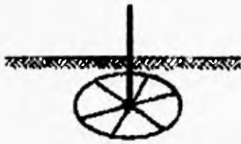
Electrodo artificial para conductor de puesta a tierra en configuración de estrella
