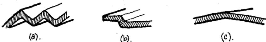
Figura 137. Otras formas de aumentar la rigidez de una pieza sin usar costillas, son: a). acanalar la pieza, b). dobleces y c). provocar curvaturas
