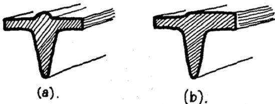
**Figura 136.** *Formas usuales para disimular hundimientos de los respaldos de costillas*
