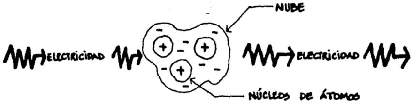
Figura 2. Nube de electrones en un enlace de tipo metálico
