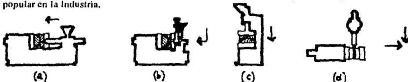
Figura 99. Esquema de las cuatro posibilidades direcciones de trabajo de las máquinas inyectoras; a). Horizontal b). Vertical con apertura horizontal c). Inyección y apertura vertical d) Inyección lateral.
