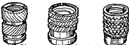
Figura 147. Diversos modelos de insertos para plásticos
