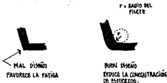
Figura 131. Ubicación correcta de radios en esquinas
