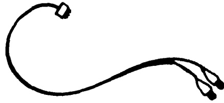
1) CABLE PARA LA CELDA
