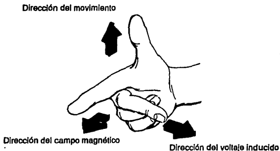
Fig 3.1. Regla de la mano derecha para voltajes inducidos en un conductor.
