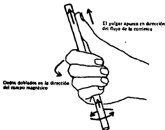
Fig 3.3. Regla de la mano derecha para la dirección de flujo magnético alrededor de un conductor.
