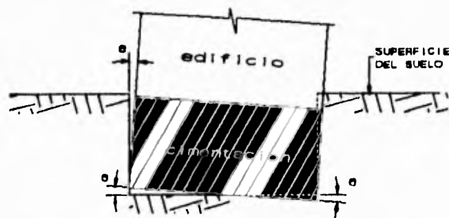
Esquema del giro de la cimentación (fuera de escala)
