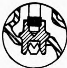
Disco de placa de doble sello y asiento reemplazable.
