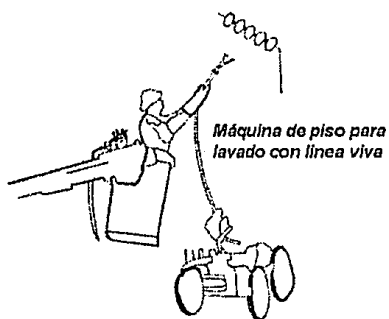
Figura 5.3.2.1.2 Máquina portátil para lavado con línea viva.
