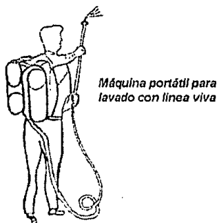
Figura 5.3.2.1.2 Máquina portátil para lavado con línea viva.
