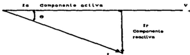
Figura 39. Componente de la intensidad de corriente por efecto del ángulo de desfase.
