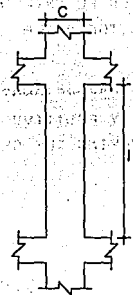
FIG 2.22 REQUISITOS PARA LAS DIMENSIONES DE COLUMNAS
