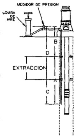
Fig. 2.1-12 Metodo para determinar el nivel de agua
