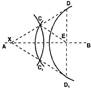
**Demostración:** Como  $C_1$  y  $D_1$  son simétricos a  $C$  y  $D$ , encontraremos el punto de intersección de las rectas dadas si encontramos el punto de intersección de las rectas  $CD$  y  $C_1D_1$ , ya que dicho punto por estar en la intersección de ambas será tal que  $CX = C_1X$  y  $DX = D_1X$ , lo cual implica que está en la mediatriz de  $CC_1$  y  $DD_1$  a la cual pertenecen  $A$  y  $B$  por construcción.
