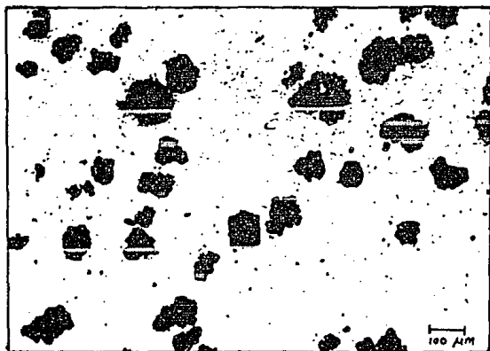
Fotografía 10 .- Compósito con 10% vol. de \alpha -Al 2 O 3 malla 200; Temp. de sinterizado = 610 °C y 10.7 ton. de presión de compactación.
