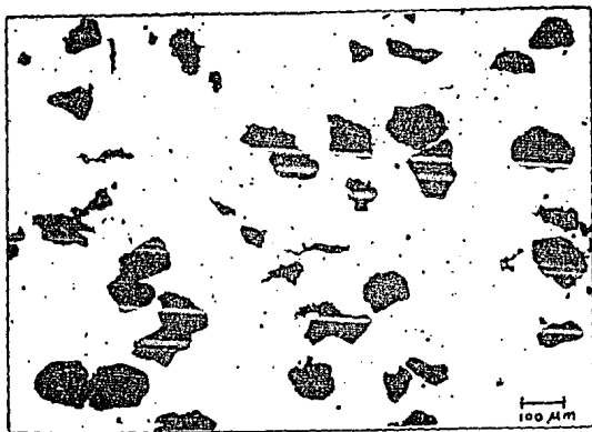
Fotografía 2 .- Compósito con 10% vol. de C(grafito) malla 200; Temp. de sinterizado = 610 °C y 10.7 ton. de presión de compactación.
