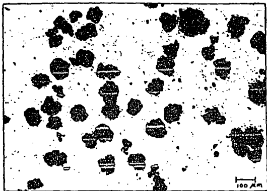
Fotografía 11 .- Compósito con 15% vol. de \alpha -Al 2 O 3 malla 200; Temp. de sinterizado = 610 °C y 10.7 ton. de presión de compactación.
