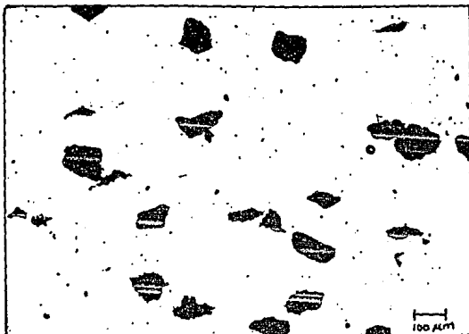
Fotografía 1 .- Compósito con 5% vol. de C(grafito) malla 200; Temp. de sinterizado = 610 °C y 10.7 ton. de presión de compactación.
