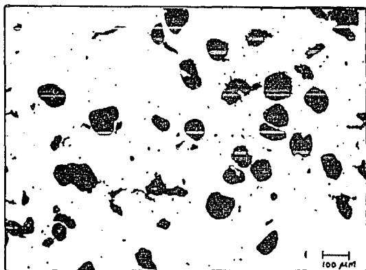
Fotografía 6 .- Compósito con 10% vol. de C(grafito) malla 250; Temp. de sinterizado = 610 °C y 10.7 ton. de presión de compactación.
