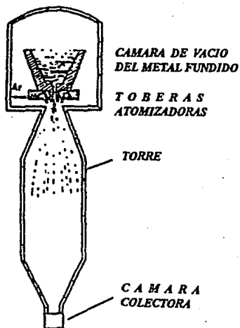
Figura 3 .- Obtención de polvos metálicos por atomización.
