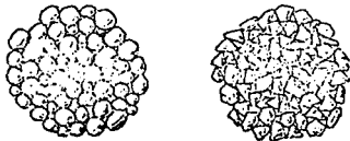
Fig 2.11. La arena de granos angulosos ( derecha ) posee mas huecos que una arena de granos redondos (izquierda ) por tanto es mas permeable.
