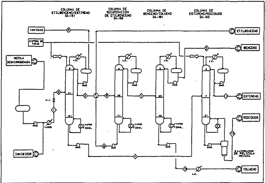
DIAGRAMA DE FLUJO DE PROCESO SECCION DE DESTILACION DE ESTIRENO
