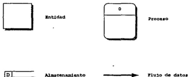
FIGURA 5.1 Los cuatro símbolos básicos usados en un diagrama de flujo de datos
