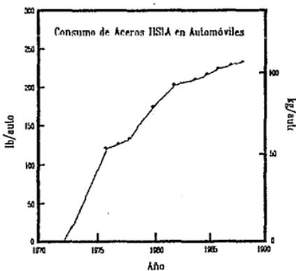
Figura 2.5. Uso de los aceros HSLA en la producción de automóviles en E. U. A.
