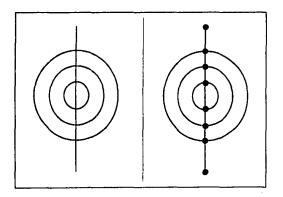
En la figura anterior se muestra el dibujo que se debe realizar de un sólo trazo y la gráfica que modela la situación. La solución será, evidentemente, localizar en la gráfica un recorrido que pase por cada una de sus aristas. En este caso no se pide que el recorrido empiece y termine en el mismo lugar por lo que buscamos solamente un "Paseo Euleriano Abierto" en la gráfica.
