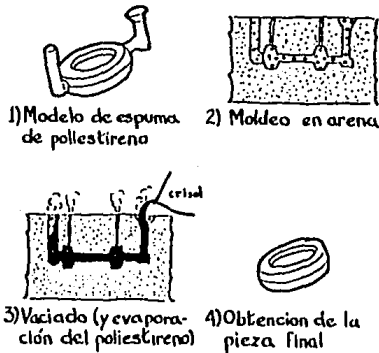
Fig 21e Proceso de molde lleno
