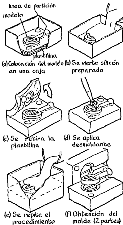
Fig 99 Fabricación de molde de silicón
