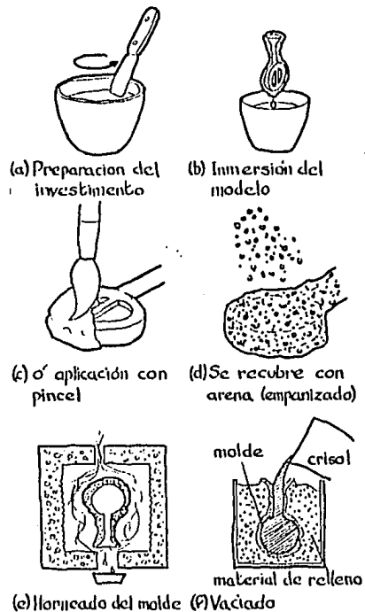
Fig 103 Fundición con modelo perdido en molde de cascara
