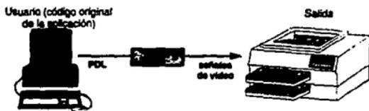
Figura 6.1. Esquema funcional de salida y lugar que ocupa un driver (la conversión a PDL del código original de la aplicación).
