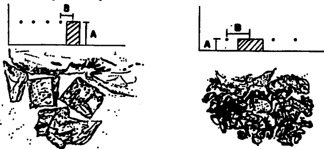
Figura II-85 Fragmentación de la roca de acuerdo a la distribución de los barrenos.
