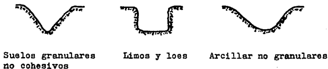
Figura II-13 Secciones transversales de los canales de escurrimiento.
