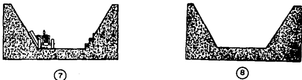
Figura II-164 Motoconformadora realizando la construcción de taludes y cortes.
