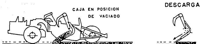
Figura II-162 Operación usual de una motoescrepa.
