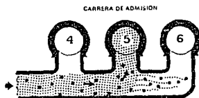
Fig. 2.42 Diagrama de distribución en un colector de admisión. Las partículas de gasolina tienden a continuar hasta el extremo del colector. Esto enriquece la mezcla que entra en los cilindros finales.
