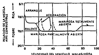
Fig. 2.24 Diagrama de la riqueza de la mezcla para diferentes velocidades del vehículo. Las velocidades a que se obtienen las diversas relaciones pueden variar en los diferentes vehículos. También puede haber alguna variación en las relaciones.
