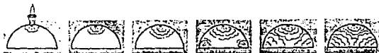
Fig. 2.11 Combustión con detonación. Hallándose a la mitad de la propagación la propia mezcla que se va quemando somete a una gran compresión a la no quemada aún, de modo que ésta explota a una velocidad mucho mayor y antes del PMS del émbolo.
