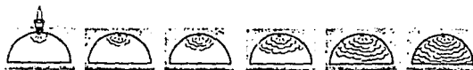
Fig. 2.10 Combustión normal. Partiendo del punto de inflamación provocado por la chispa de la bujía, la combustión se va propagando sucesivamente en ondas a lo largo de la cámara.
