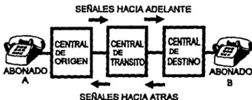
Figura 2.4.2. Señales de línea entre centrales.
