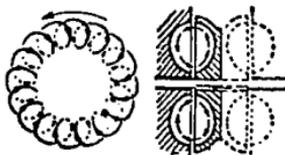
Esquema de funcionamiento hidráulico del freno Froude.
