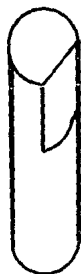
Fig. 3.02 FORMA QUE PRESENTABAN LAS MUESTRAS CON UNA PEQUERA MUESCA PARA SER PRESIONADA CON UN TORNILLO
