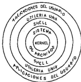
Figura 2.15 Componentes del sistema UNIX
