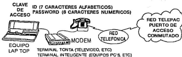
Figura 2.31 TELEPAC acceso a Red Telefónica conmutada (asíncrono a una velocidad de 300-2400 bps)
