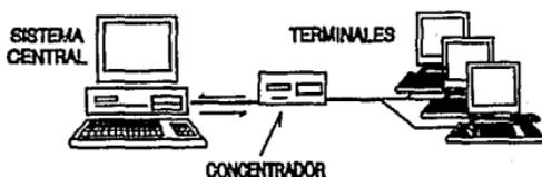
Figura 1.7 Realización de un enlace multipunto
