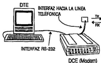
Figura 1.22 El modem en el proceso de transmisión
