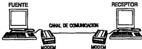
Figura 1.6 Realización de un enlace punto a punto
