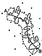
FIGURA 13.- Modelo de reptación donde la trayectoria real es representada por la trayectoria A-B.
