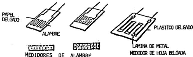
FIGURA II.4. MEDIDORES DE DEFORMACIÓN TIPO MALLA
