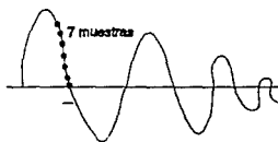
Ilustrac. 5 Componentes de una señal analógica
