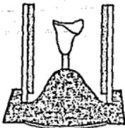
Una vez que se obtiene el patrón de cera, se une a él un cuele para colado y se recubre con revestimiento el cual se mezcla de la misma manera que el yeso piedra, se coloca alrededor del patrón y se deja fraguar. Después que endurece se retira el cuele, al igual que la cera, y se hace entrar el metal fundido dentro de la cavidad del molde que deja la cera, através del bebedero o conducto formado por el cuele.
