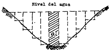
Fig. 2.1 Forma de subdividir un cauce para valuar el gasto.
