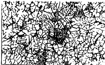
Figura 9.10 Estructura dendrítica, ya no se aprecia porosidad y las áreas eutécticas son más grandes. Presión de solidificación 12.506 \text{ KN/cm}^2 Ataque: reactivo Ferryman. 100 X
