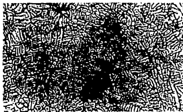
Figura 9.11 Estructura dendrítica, sin porosidad y las áreas eutécticas son más grandes aún. Presión de solidificación 15.633 \text{ KN/cm}^2 Ataque: reactivo Ferryman 100 X
