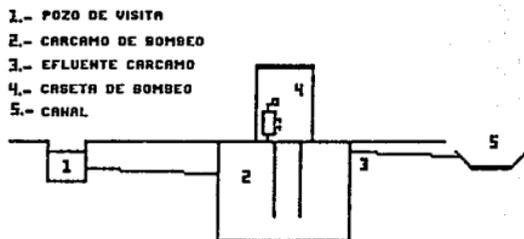
**FIG. 2. PUNTOS DE MUESTREO DE LA DESCARGA DE AGUA RESIDUAL DEL CONJUNTO HABITACIONAL.**
