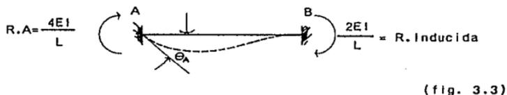
Si el apoyo A gira un ángulo  $\Theta_A = 1$  radián, la barra deformada aparece con línea punteada.
