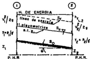
FIG.1.5 Aplicación de la ecuación de la energía.
