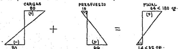
Cálculo del acero negativo y de la conexión entre traveses, para formar el marco.
