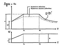
Se debe de tomar encuenta que la reducción de fuerzas sísmicas por ductilidad, es válida para el cálculo de fuerzas, pero no para el cálculo de desplazamientos. Los desplazamiento elastoplásticos quedarán iguales a los elásticos.
