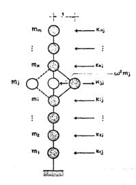
Cuando  $m_i$ tiene el despiazamiento igual a 1, estará sujeta a una fuerza  $k_{ii}$  que causa ese despiazamiento y a una fuerza de inercia de valor igual a : masa x aceleración:  $m_i$  x  $\omega^2$  x despiazamiento.
