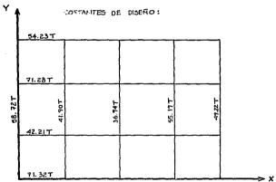
Del análisis anteriormente realizado se obtuvieron las fuerzas cortantes de diseño del primer entrepiso, para los entrepisos siguientes se realiza el mismo análisis con el fin de obtener los cortantes de diseño en cada uno de los entrepisos del edificio. La obtención de los cortantes de diseño es el último proceso contemplado en los alcances de la presente tesis, posteriormente a este análisis se requieren los siguientes pasos con el fin de encontrar los elementos mecánicos de diseño sísmico.
